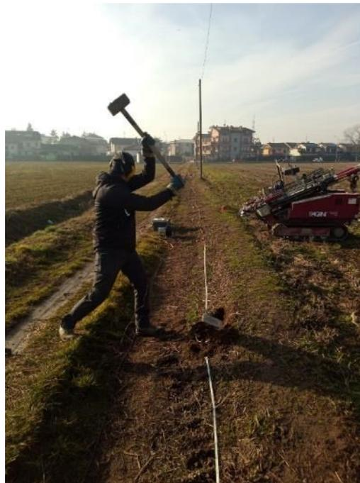
Per l'acquisizione sismica è stato impiegato un sismografo modulare (Geode Geometrics Mod. 3-1000) con un sistema di ricezione costituito alternativamente da uno stendimento di 24 geofoni a movimento verticale (Geospace GS11D) e da uno stendimento di 24 geofoni a movimento orizzontale (Senseh con livello a bolla), entrambi a frequenza di 4,5 Hz e puntali da 3", collegati mediante un cavo multielettrodo.
