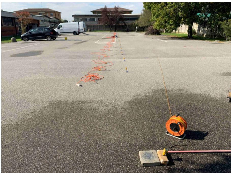
Foto 8: Prova Sismica MASW
