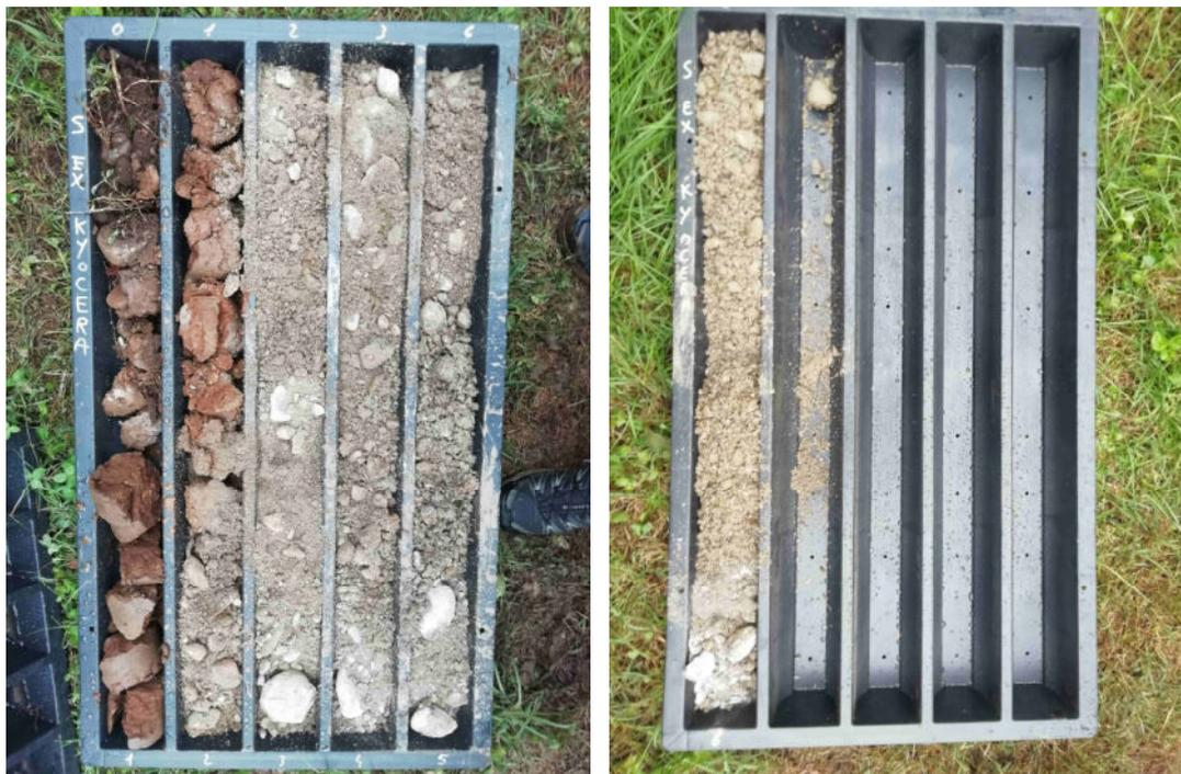
Figura 9: Stratigrafia rilevata nel sondaggio
