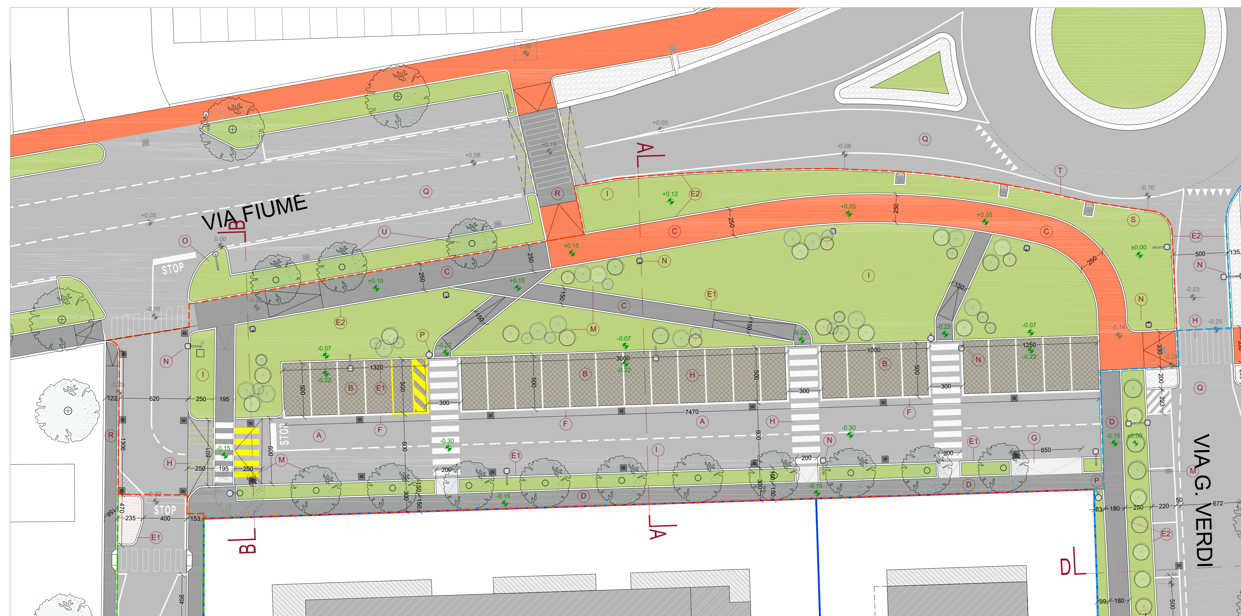
REALIZZAZIONE NUOVO PARCHEGGIO E VIABILITA' DI ATTESTAMENTO PLANIMETRIA OPERE SOPRASUOLO IN PROGETTO - scala 1:200
