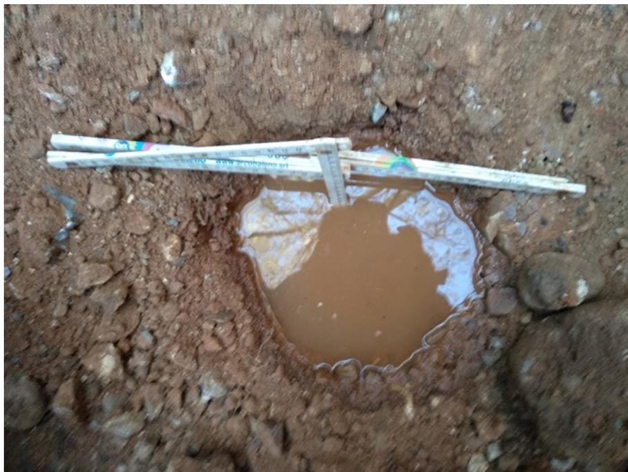
Figura 8: Particolare della prova di permeabilità eseguita.
