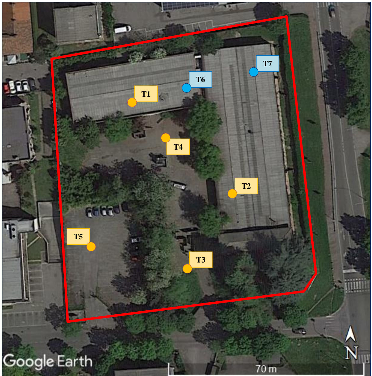
Figura 4 – Ubicazione delle verticali di indagine, in giallo le verticali previste dal piano di indagine preliminare, in azzurro le verticali integrate da ARPA Lombardia (fonte: Google Earth)
