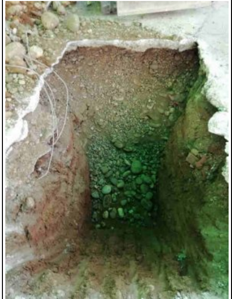
Foto 2: Stratigrafia trincea T1 sul fondo trincea i ciottoli grossolani dello strato tecnico sotto soletta
