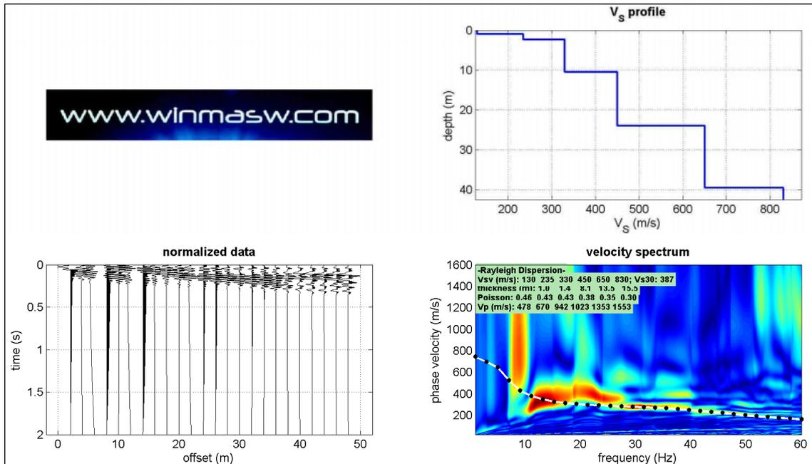
Figura 13: Interpretazione prova MASW con software Winmasw 3C ©
