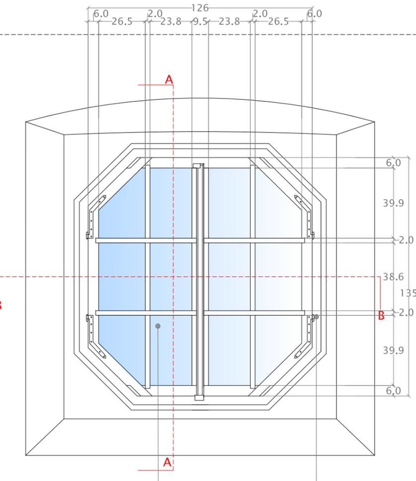
N.4 specchiature rettangolari e n.2 specchiature trapezoidali per anta, divise con traversini in legno)
