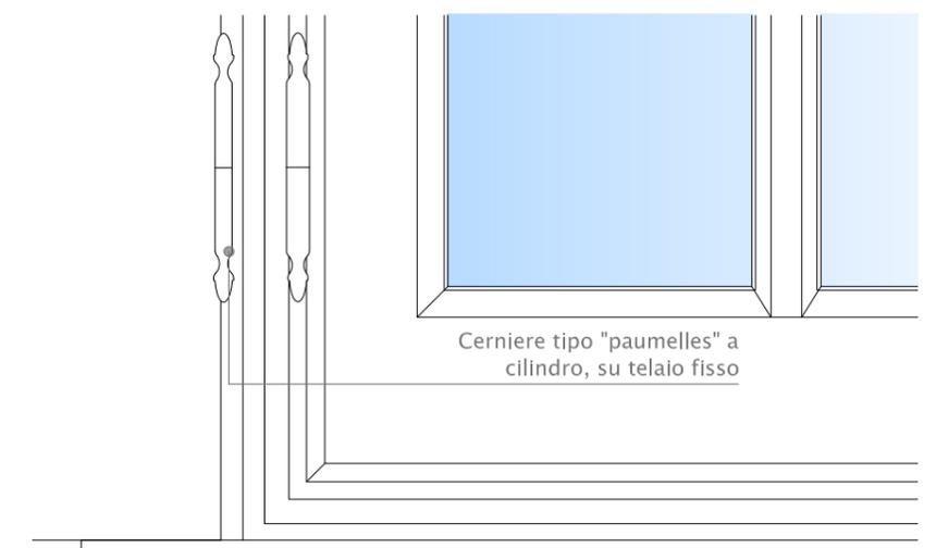
Cerniere tipo "paumelles" a cilindro, su telaio fisso
