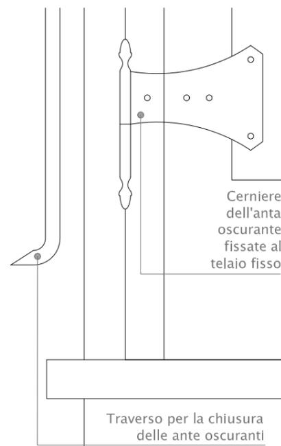
Cerniere dell'anta oscurante fissate al telaio fisso
