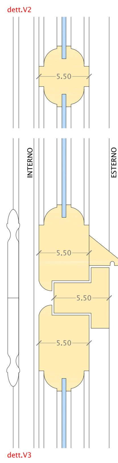
Telaio fisso con dentello esterno da 3,5 cm
