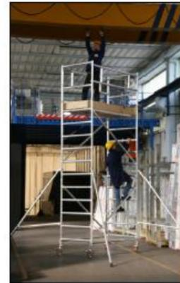
Con l'aggiunta al Modulo A del modulo intermedio C dotato di 4 staffe e del modulo terminale B Jolly può essere montato all'altezza di m 4,47 con un'altezza di lavoro di m 3,70. (A+B+C=24 pezzi da assemblare - Kg 108).
