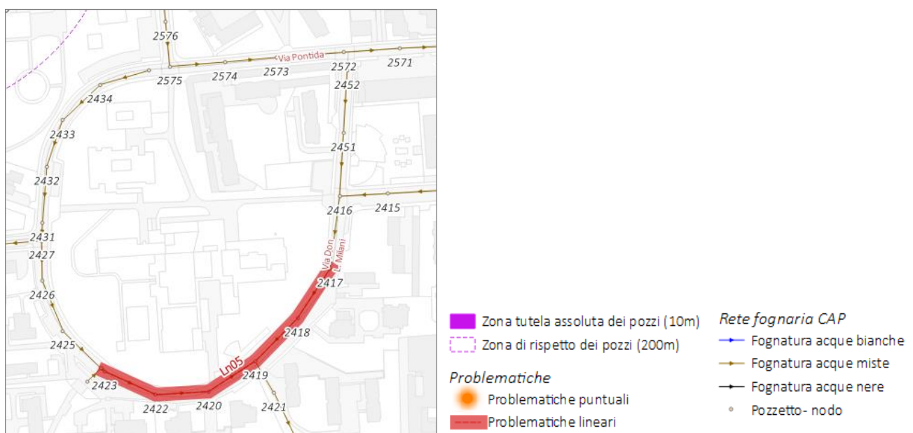
Figura 30 - Estratto delle Tavola 2 con indicazione delle problematiche riscontrate
