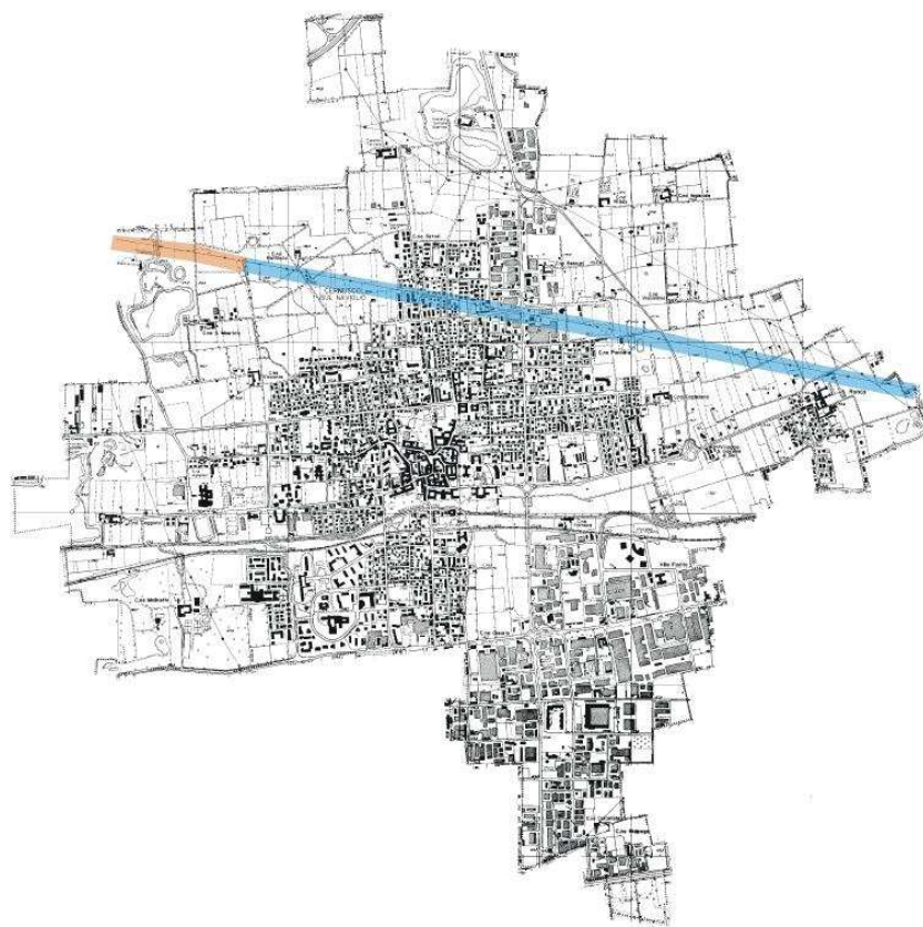
Figura 29 Area oggetto dell'analisi effettuata (in arancione l'area della cava in cui il tracciato è stato sottoposto a variante) (fonte: Analisi dei livelli di esposizione all'induzione magnetica a 50 Hz dalla linea elettrica a 220 kV "Sesto-Cassano" di Edison Rete SpA, 2004)
