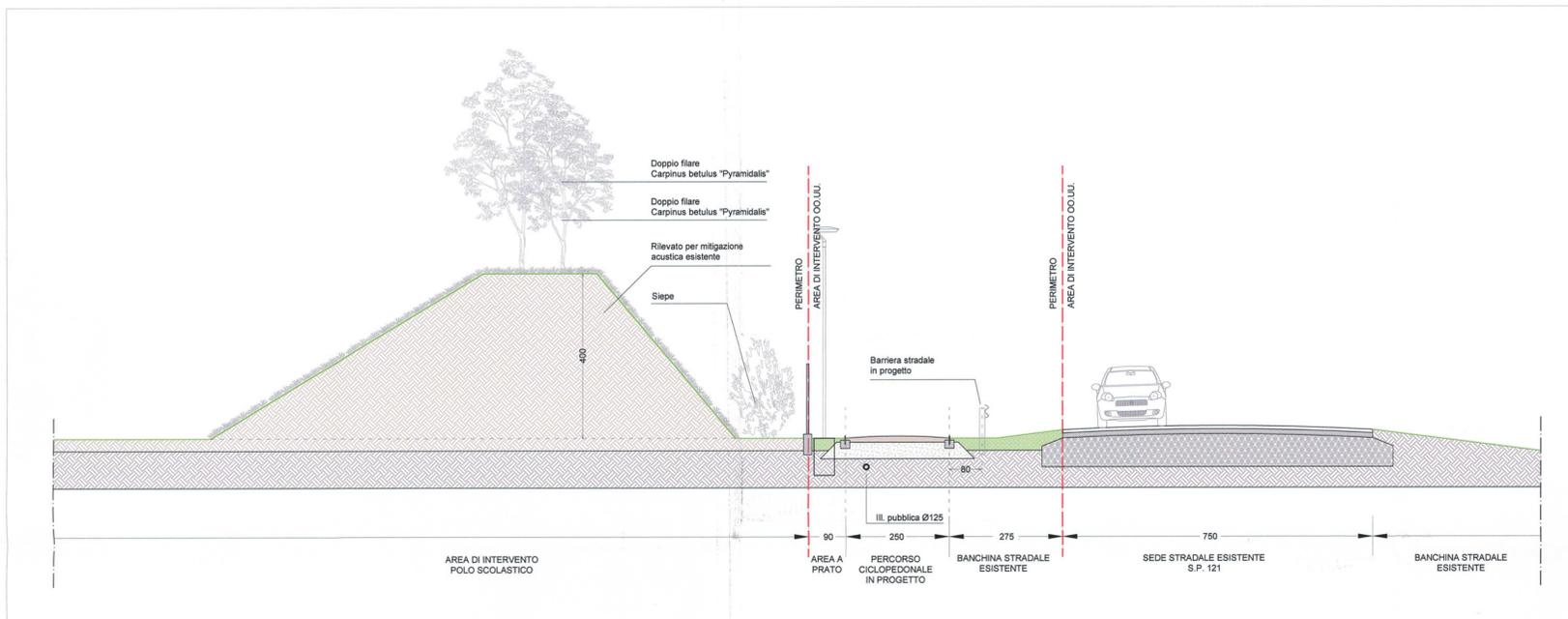
SEZIONE DD - Rilevato per mitigazione ambientale esistente
