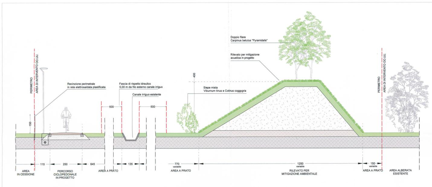
SEZIONE BB - Rilevato per mitigazione ambientale in progetto /2
