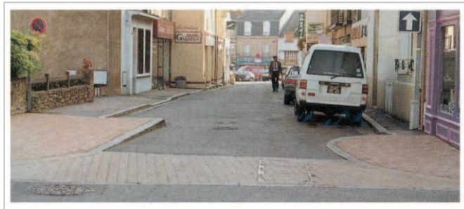
Figura 7.1.24– Impiego di “orecchie” ad un incrocio
