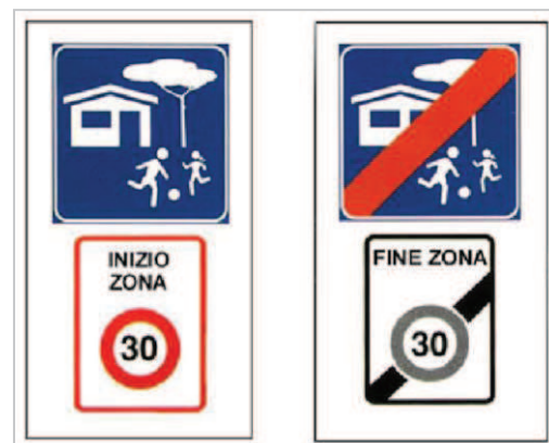
Figura 7.1.14– Segnaletica di Ingresso/Uscita di una Zona 30
