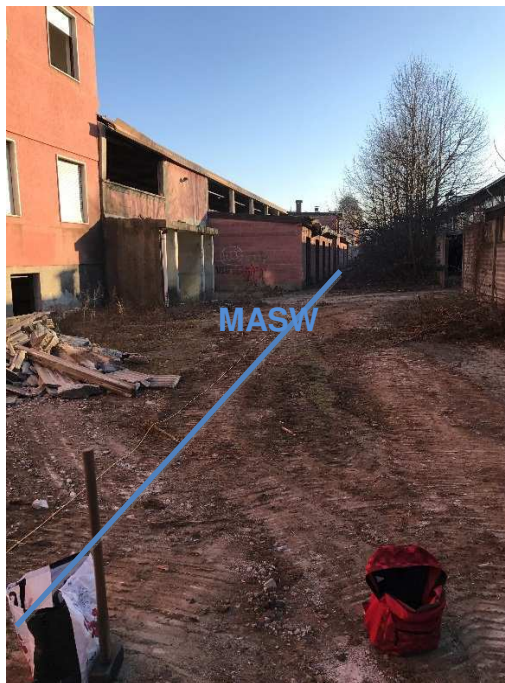
Foto 2: Stendimento prova sismica MASW
