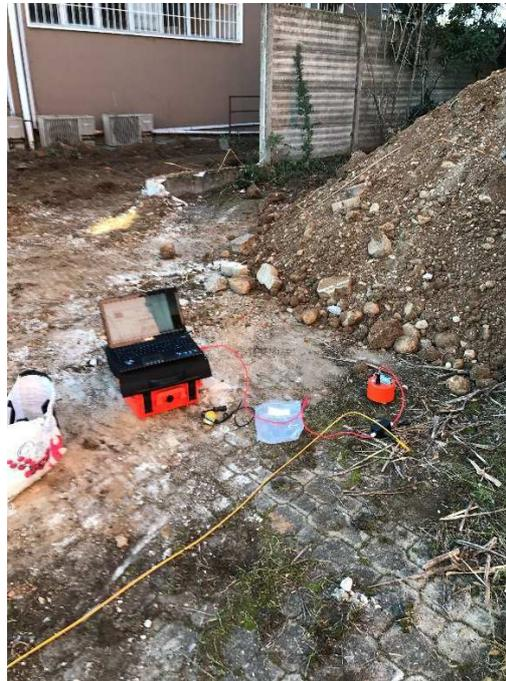
Foto 1: Strumentazione MASW
