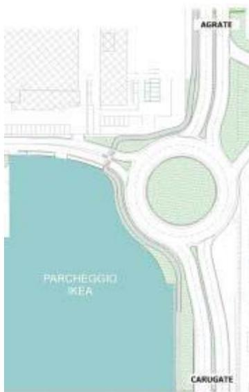
La rotonda progettata avrà un diametro di circa 48 metri e prevede la circolazione sull'anello su due corsie di marcia. Per quanto riguarda i rami d'ingresso e di uscita, nel caso della SP121 sono previsti attestamenti a doppia corsia, mentre per Via dell'Artigianato è previsto l'attestamento singolo.
