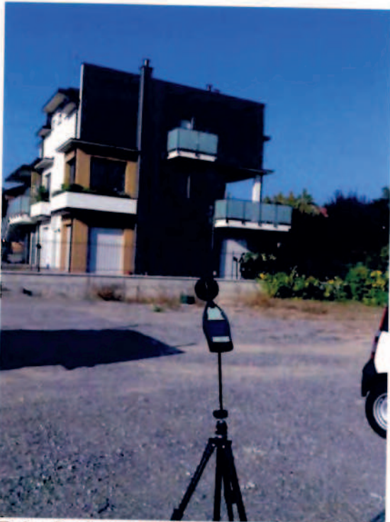
Foto 3: Fonometro posto in R3. La stazione di misurazione R3 coincide con la zona in cui verranno edificati gli edifici più vicini alla via Monza
