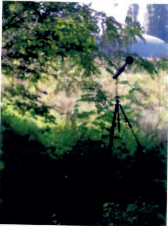
Foto 2: Fonometro posto in R2. La stazione di misurazione R2 coincide con la zona in cui verranno edificati sul lato Ovest gli edifici più vicini alla via Fontanile (distanza da strada: 20,95 metri). Seppur R2 si trovi ad una distanza minore (circa 4,39m) dalla strada rispetto ad R1, il livello equivalente in R2 risulta minore nel periodo notturno, in quanto il lato Ovest risulta essere schermato da una vegetazione più fitta e da un canale, rispetto ad R1.
