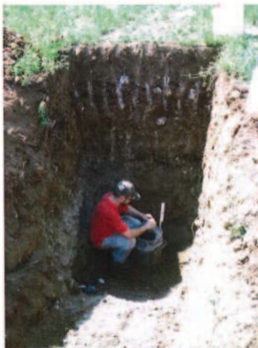
Fig. 3- prova infiltro metrica k2 eseguita all'interno della trincea T2
