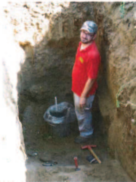
Fig. 2- prova infiltro metrica k_1 eseguita all'interno della trincea T1
