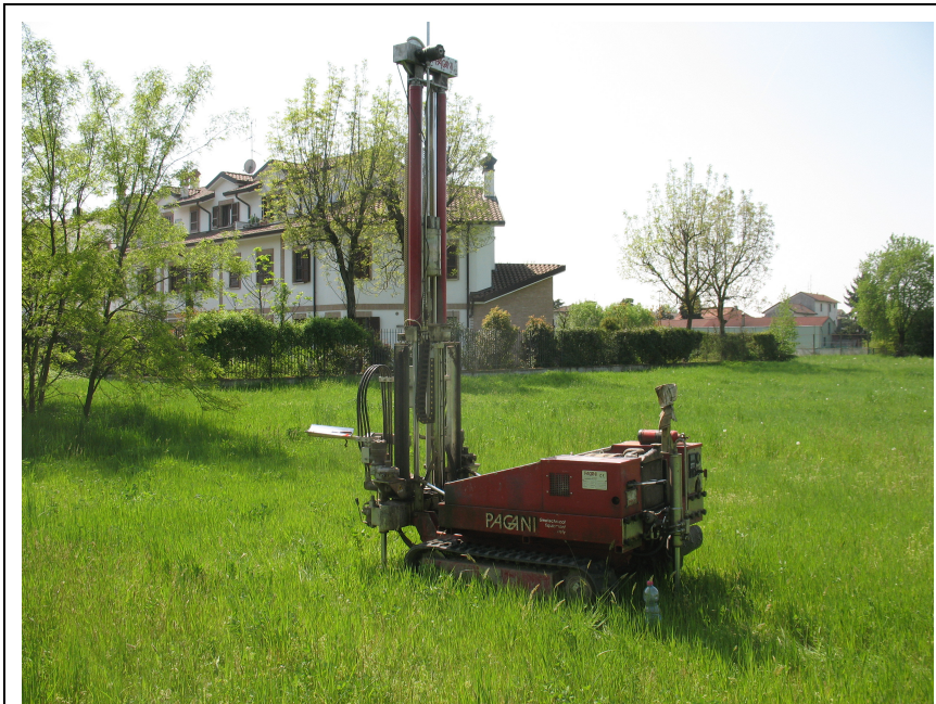
Foto 11: Ripresa dell'esecuzione dell'SCPT13
