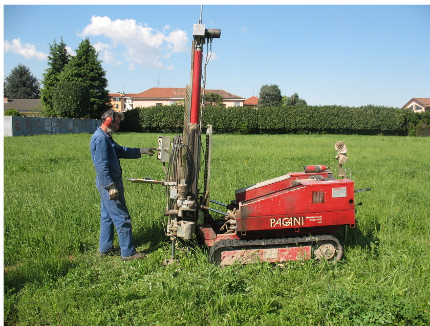
Foto 5: Ripresa dell'esecuzione dell'SCPT7
